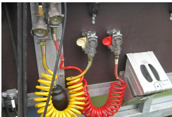
zukuntorientiertes Kombi – Bremssystem für Traktoren mit Einleiter Hydraulikbremsen oder für Traktoren mit EU Druckluftbremsanlage
