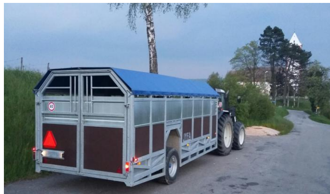
komplett feuerverzinkter Aufbau
