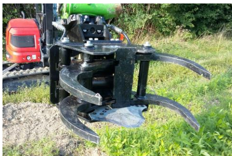
Schlanke, robuste Arme für höchst mögliche Übersicht beim Schneideingriff
