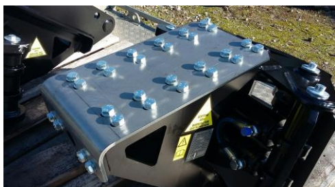
optional "leere", geschraubte Anbauplatte für die Aufschiessung vieler Schnellwechslertypen komplette Platten mit LENHOFF MS 01, 03, 08
